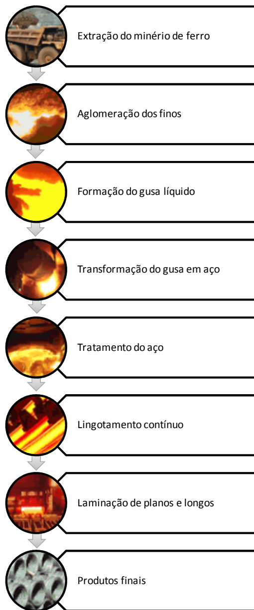
Figura 2.8 - Fluxo da produção do aço.
